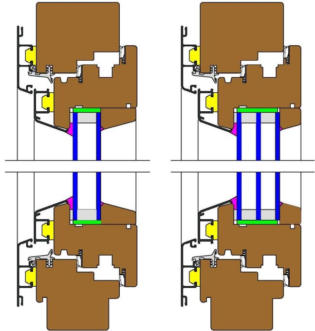
Qualität und Beständigkeit zeichnen das moderne Holz-Aluminium Fenstersystem aus. Durch die baugleiche Innenansicht lässt sich dieses System einwandfrei mit Holzfenstern kombinieren, es könnte somit auch nur auf der Wetterseite eingesetzt werden. Die innere Massivholz Oberfläche ist atmungsaktiv und ist wesentlich an der Regelung des Raumklimas beteiligt.
